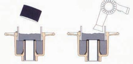
筒下カバー上部に被さるように熱収縮チューブを立上がり筒に被せる
