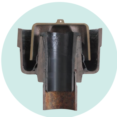
補修後のトラップ断面図
