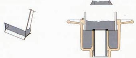
筒下カバーの内側に指定接着剤を充填して、トラップ立上がり筒にセット
