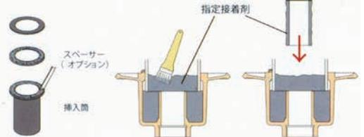
挿入筒の上部に指定接着剤を塗布して、トップカバーを取り付ける
