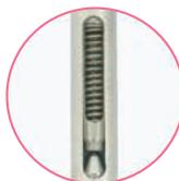
地震の時、建物が大きく変形すると、ドア枠も建物と同様に変形し、ドアの開閉にも影響を及ぼします。対震丁番にはスプリングが内蔵されており、ドア枠が変形した場合でも、小さな力でドアを開けることができ、地震時の避難に有効です。
